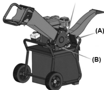
(A) Placa de bloqueio nº 16 para funil de saída (B) Placa de bloqueio nº. 15 para saco coletor
