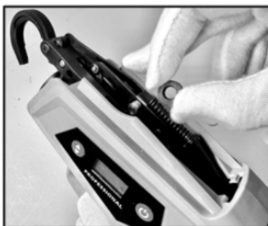
7. Sostituire la cinghia di gomma con una nuova. Assicurati che la fessura al suo interno sia rivolta verso l'esterno.
