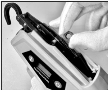
7. Reemplace la correa de goma por una nueva. Asegúrese de que la ranura de la misma quede hacia afuera.
