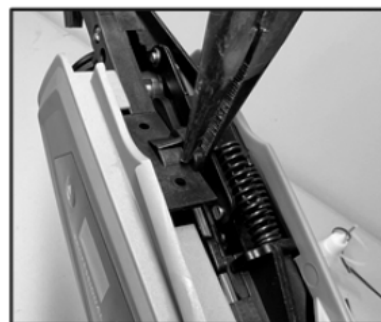
9. Installez la plaque de protection gauche
