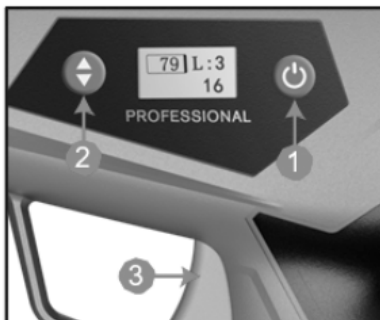
5. Ligue o tyer, pressione e segure o botão de mudança de marcha por 1 segundo. e ative o gatilho quando ouvir um som.
