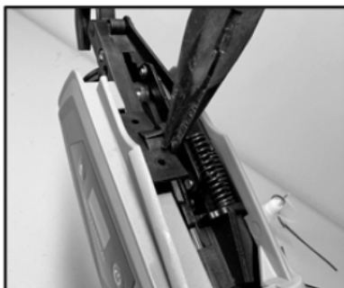
4. Rimuovere la piastra di copertura sinistra
