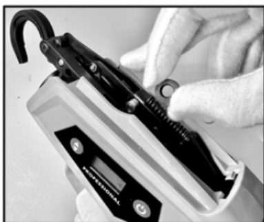
7. Substitua a correia de borracha por uma nova. Certifique-se de que o slot esteja voltado para fora.
