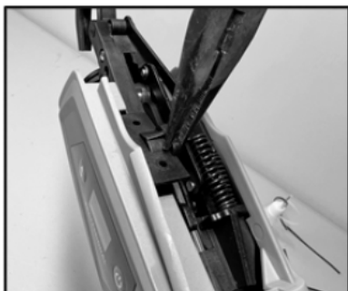
4. Retirez la plaque de protection gauche
