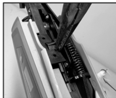
9. Instale a tampa esquerda
