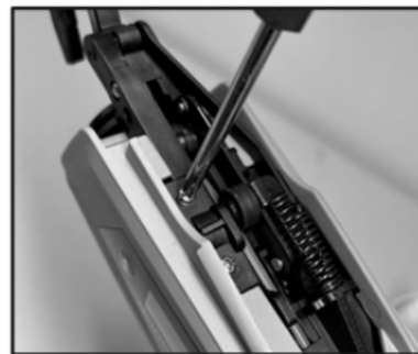
3. Allentare le viti sulla piastra di copertura sinistra
