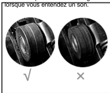
8. Schéma de la différence des courroies en caoutchouc.
