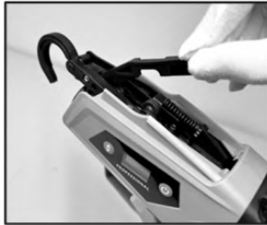
2. Retire la placa de sujeción.
