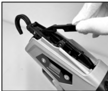
2. Remova a placa de fixação.
