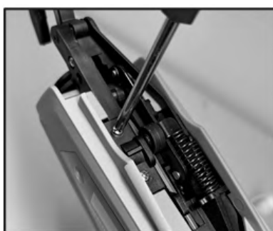
10. Serrez les vis sur la plaque de recouvrement gauche.
