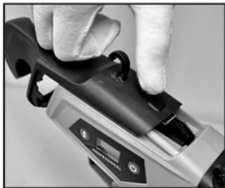
13. Reinstale a tampa protetora
