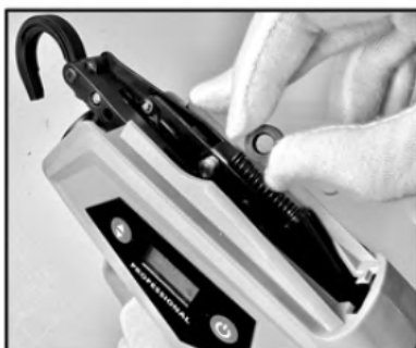
7. Sostituire la cinghia di gomma con una nuova. Assicurati che la fessura al suo interno sia rivolta verso l'esterno.
