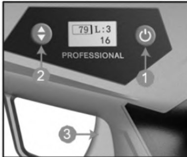
5. Encienda la atadora, mantenga presionado el botón de cambio de marcha durante 1 seg. y luego active el gatillo cuando escuche un sonido.
