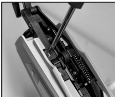
10. Apriete los tornillos en la placa de cubierta izquierda.
