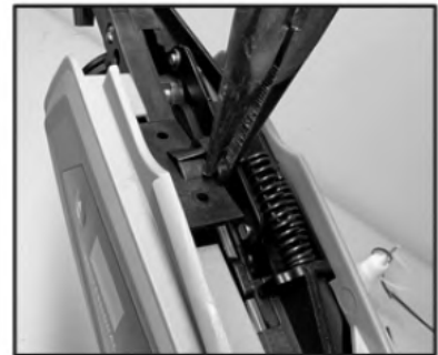
9. Instale la placa de cubierta izquierda
