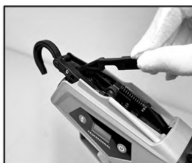
11. Installare la striscia di pressione
