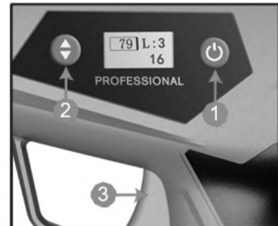
12. Encienda la alimentación, presione y mantenga presionado el botón de cambio durante 1 segundo y luego active el gatillo
