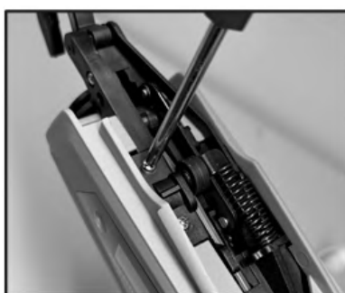
10. Ziehen Sie die Schrauben an der linken Abdeckplatte fest.
