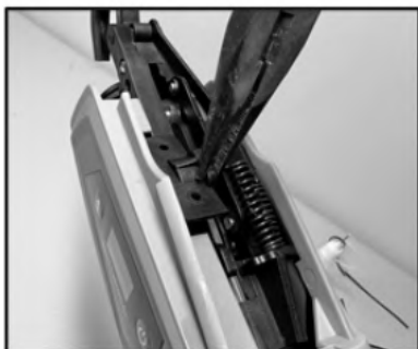
4. Retirez la plaque de protection gauche
