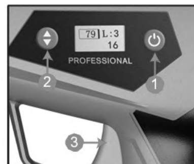
12. Accendere l'alimentazione, tenere premuto il pulsante shift per 1 secondo, quindi premere il grilletto
