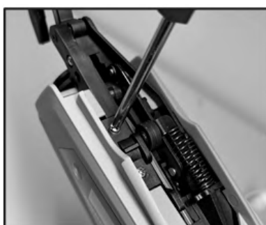
10. Serrare le viti sulla piastra di copertura sinistra.
