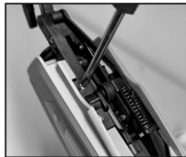
3. Desserrez les vis sur la plaque de recouvrement gauche
