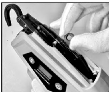
7. Ersetzen Sie den Gummiring durch einen neuen. Stellen Sie sicher, dass der Schlitz nach außen zeigt.
