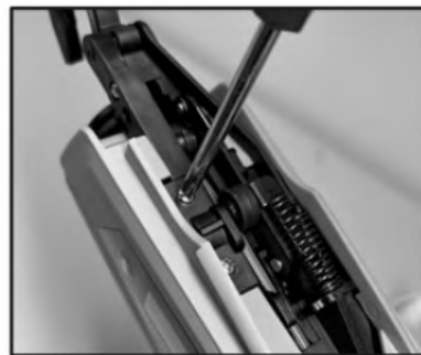
3. Solte os parafusos na placa da tampa esquerda
