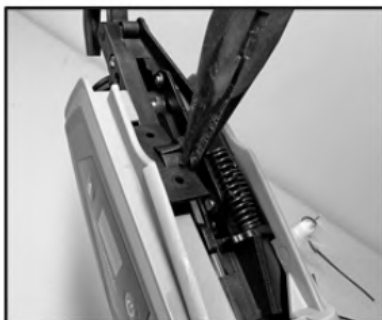
4. Entfernen Sie die linke Abdeckplatte
