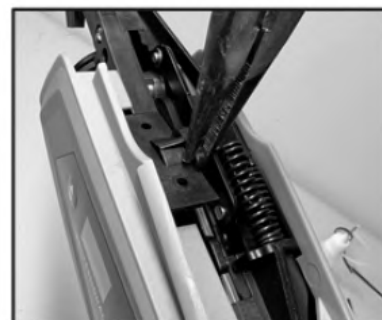
9. Installare la piastra di copertura sinistra
