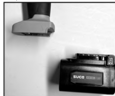
6. Rimuovere la batteria
