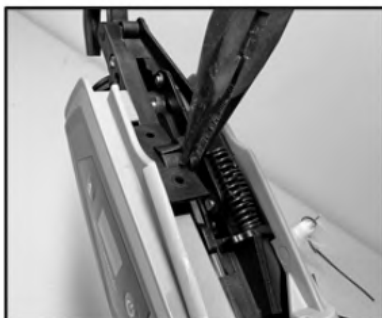
4. Rimuovere la piastra di copertura sinistra
