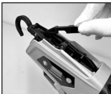
2. Rimuovere la piastra di fissaggio.
