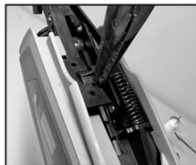
9. Installez la plaque de protection gauche
