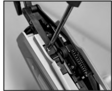
3. Afloje los tornillos en la placa de cubierta izquierda
