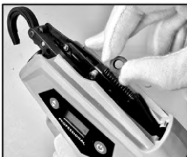
7. Remplacez la courroie en caoutchouc par une neuve. Assurez-vous que la fente qu'il contient est tournée vers l'extérieur.
