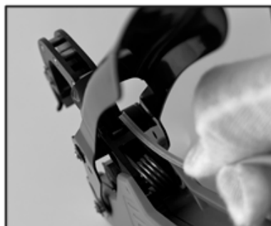
4. Führen Sie den Draht von der Unterseite des Binders ein.
