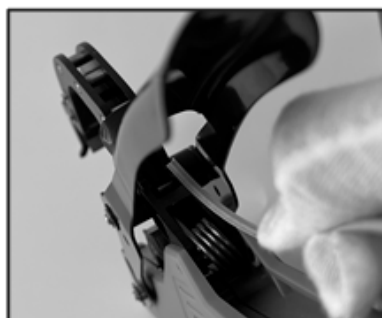
4. Insérez le fil depuis la partie inférieure des pinces à lier.
